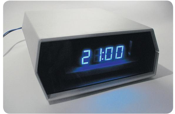
Bild 2: Selbst gefertigte Digitaluhr – aufgebaut nur mithilfe eines Mikrocontrollers
