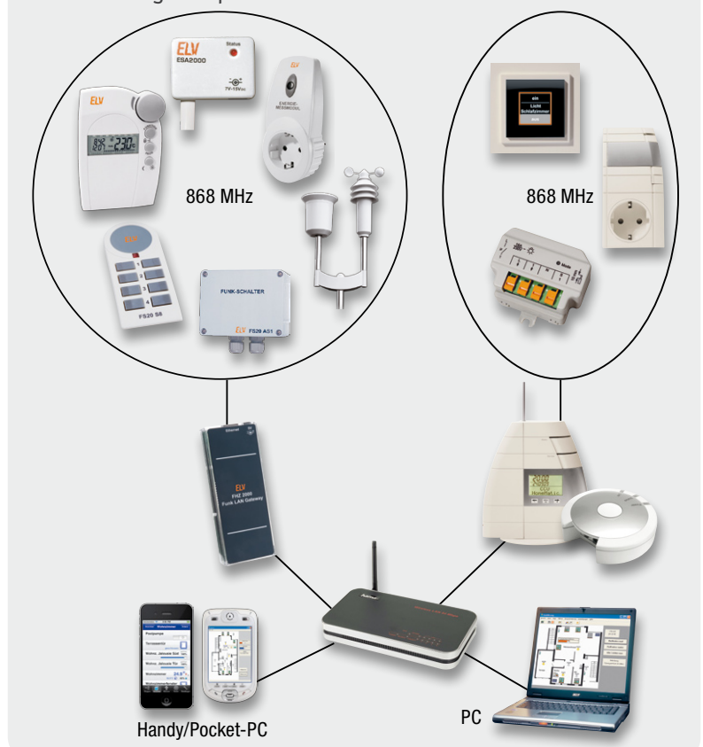
Bild 4: Unter der neuen homeputer-Softwareoberfläche sind alle von der FHZ 2000 verarbeitbaren Protokolle und das HomeMatic-System zusammengeführt.
