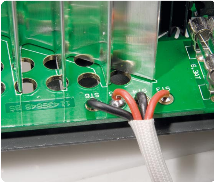
Bild 21: Anschluss der Lautsprecher-Ausgangsleitungen an die Platine
