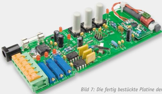
Bild 7: Die fertig bestückte Platine der Uhr
