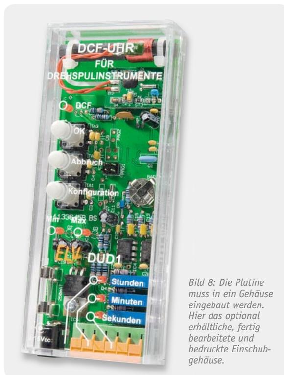
Bild 8: Die Platine muss in ein Gehäuse eingebaut werden. Hier das optional erhältliche, fertig bearbeitete und bedruckte Einschubgehäuse.
