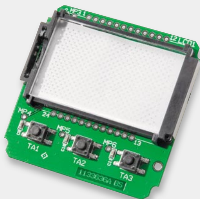
Bild 17: Einsetzen der Lichtverteilerplatte
