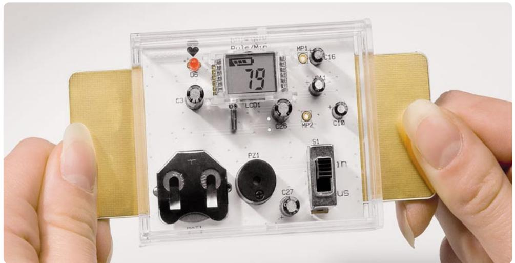
Nun kann die Platine in das Gehäuse eingebaut werden. Dies ist relativ einfach und ohne Schrauben zu bewerkstelligen. Die Platine wird hierzu in die Gehäuseoberschale gelegt, und anschließend wird das Gehäuseunterteil aufgesetzt bzw. beide Gehäusenhälften zusammengeschoben.
