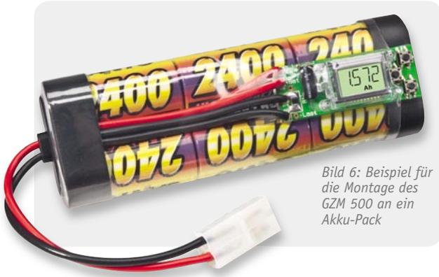
Bild 6: Beispiel für die Montage des GZM 500 an ein Akku-Pack
