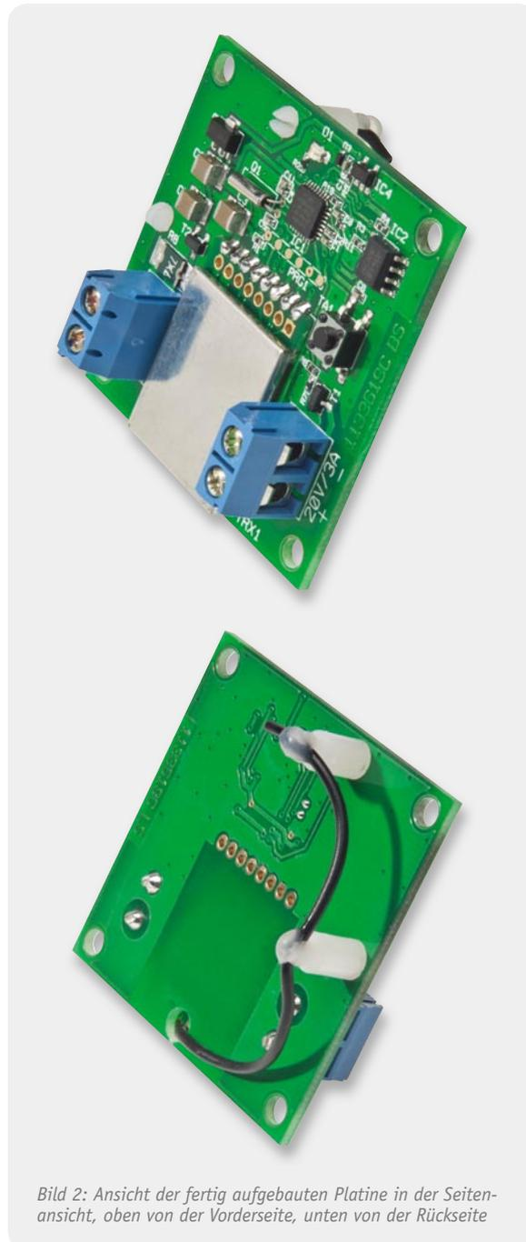
Bild 2: Ansicht der fertig aufgebauten Platine in der Seitenansicht, oben von der Vorderseite, unten von der Rückseite
