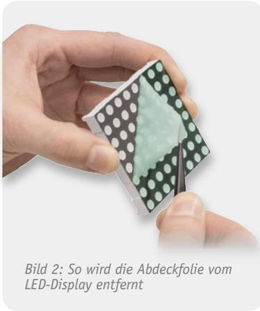
Bild 2: So wird die Abdeckfolie vom LED-Display entfernt
