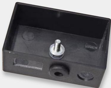
Bild 10: Verschraubung der Kabelbinderschellen an der Gehäuseinnenseite
