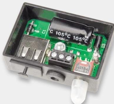
Bild 12: In das Gehäuse eingebaute Elektronik
