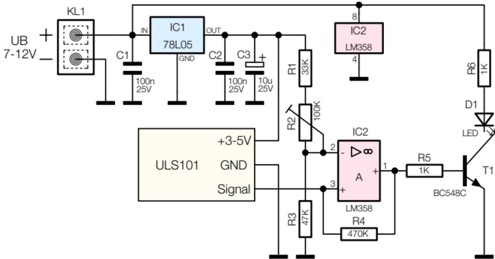
Bild 9: Eine Anwendungsschaltung als Beispiel für den Einsatz des Helligkeitssensors, ein in der Ansprechempfindlichkeit einstellbarer Dämmerungsschalter
