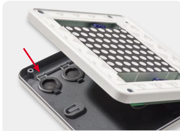
Bild 12: Vor dem Aufsetzen der Gerätefront werden die Tastkappen so ins Unterteil gelegt, dass die Stege nach außen zeigen.
