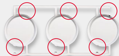
Bild 6: Einige der Stege an den Tastkappen werden an den markierten Stellen vorsichtig herausgetrennt, wodurch sich die Tasten leichter betätigen lassen.
