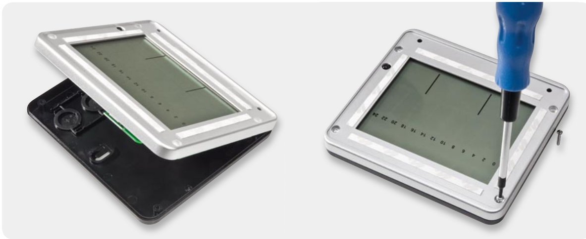
Bild 15: Das vormontierte Gerät mit der Gehäuseoberschale wird in die Gehäuseunterchale eingelegt (links) und mit vier Schrauben (rechts) verschraubt.
