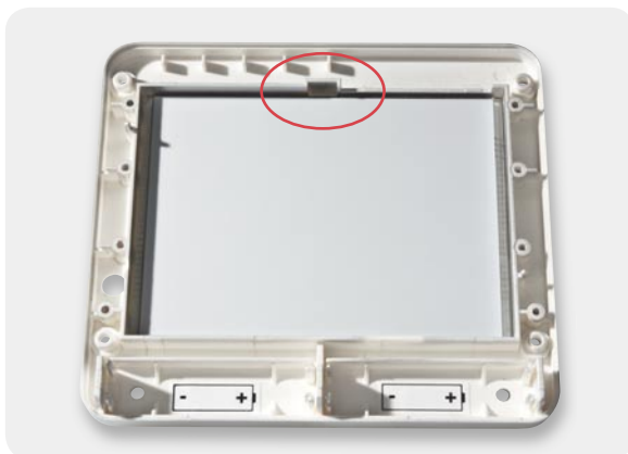
Bild 11: Das Display ist so einzulegen, dass der Display-Anguss genau in der dafür vorgesehenen Gehäusenut liegt. Achtung: Display-Schutzfolie entfernen!
