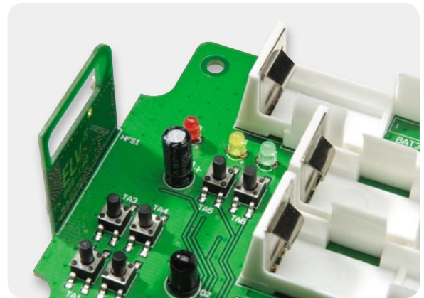
Bild 8: Beim Anlöten des Sendemoduls ist auf eine rechtwinklige Ausrichtung zu achten.
