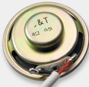
Bild 8: Montage der doppelt isolierten Lautsprecherleitungen am Lautsprecher
