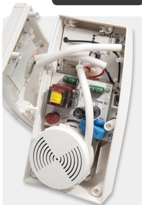
Bild 11: Die Lage aller Komponenten (inkl. Verlegung der Lautsprecherleitung) vor dem Zusammenbau des Gehäuses
