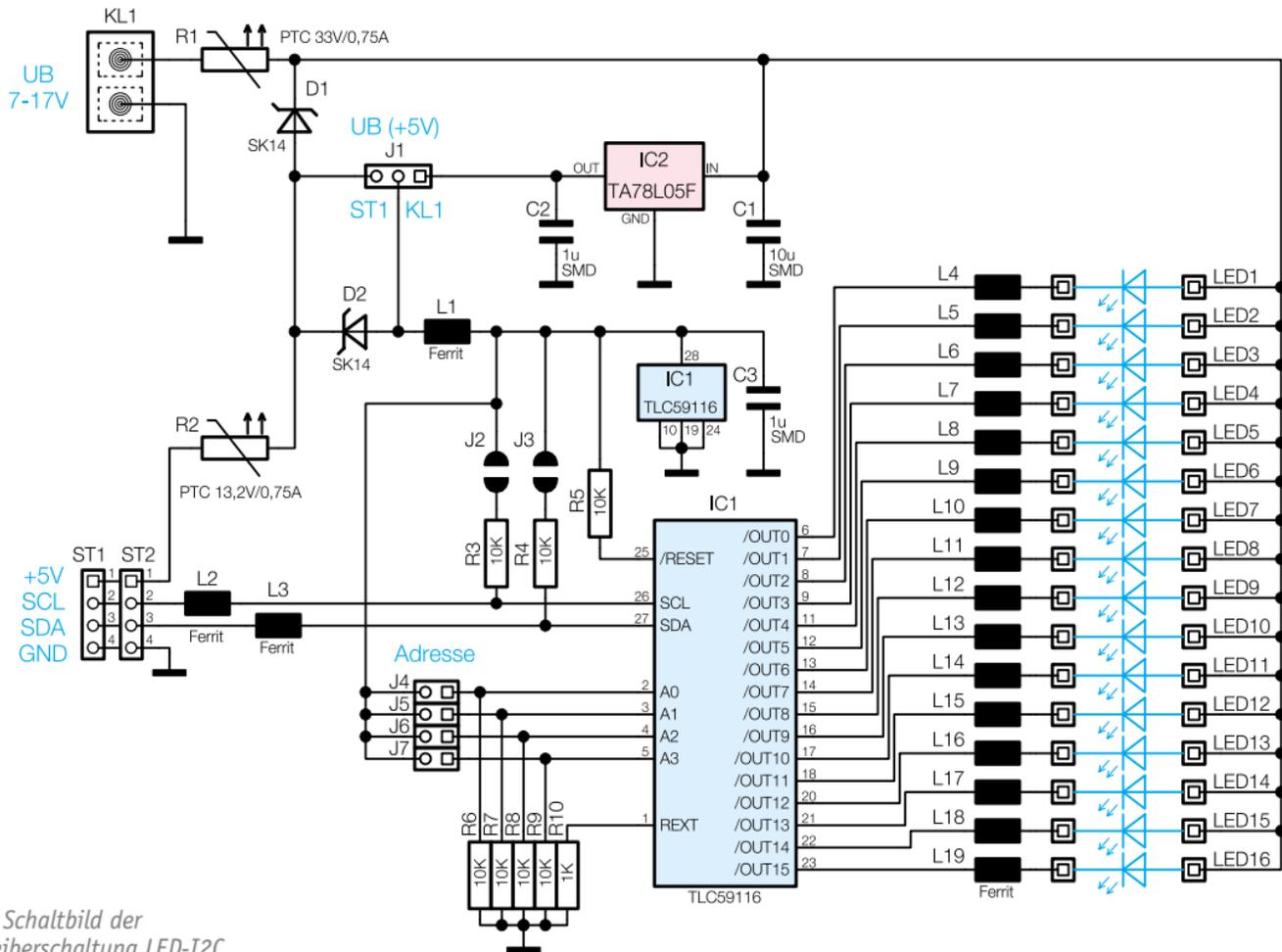
Bild 1: Schaltbild der LED-Treiberschaltung LED-I2C
