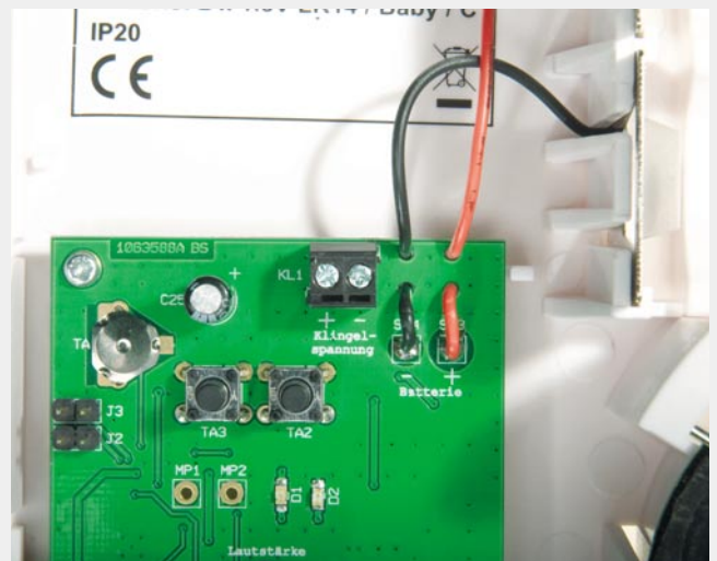
Bild 7: So werden die Leitungen zum Lautsprecher (links) und zu den Batteriekontakten (rechts) verlötet. Die Batterieleitungen sind zur Fixierung – wie hier gezeigt – durch die Löcher in der Platine zu führen.
