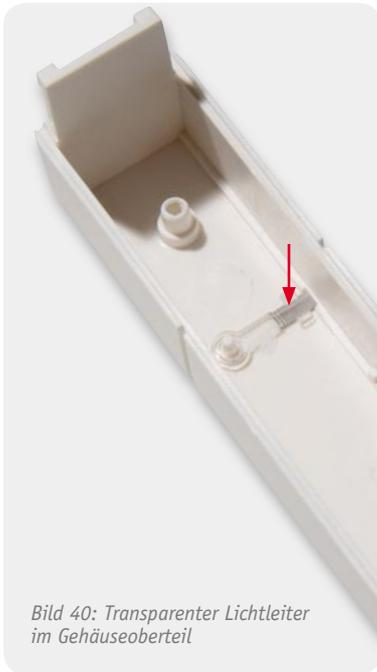
Bild 40: Transparenter Lichtleiter im Gehäuseoberteil
