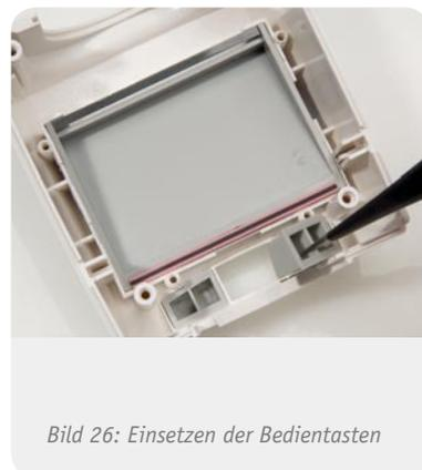
Bild 26: Einsetzen der Bedientasten
