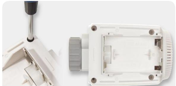
Bild 35: Verschrauben der beiden Gehäusehälften
