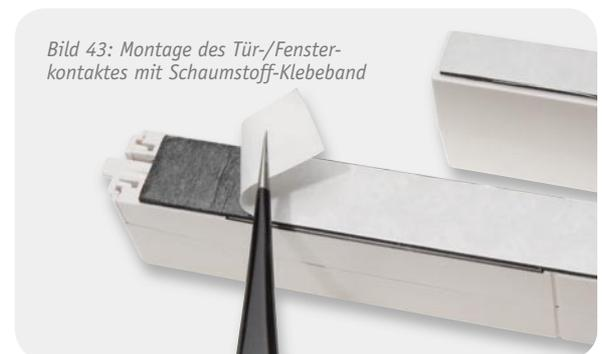
Bild 43: Montage des Tür-/Fensterkontaktes mit Schaumstoff-Klebeband
