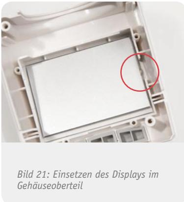
Bild 21: Einsetzen des Displays im Gehäuseoberteil
