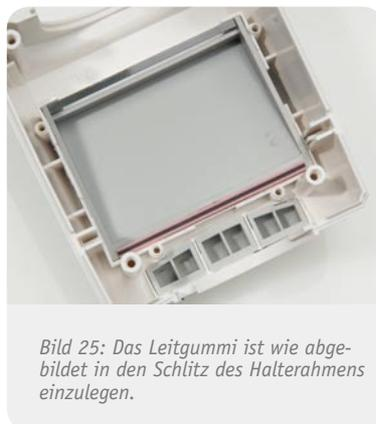
Bild 25: Das Leitgummi ist wie abgebildet in den Schlitz des Halterahmens einzulegen.
