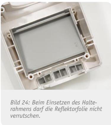
Bild 24: Beim Einsetzen des Halterahmens darf die Reflektorfolie nicht verrutschen.
