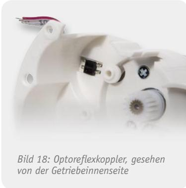
Bild 18: Optoreflexkoppler, gesehen von der Getriebeinnenseite
