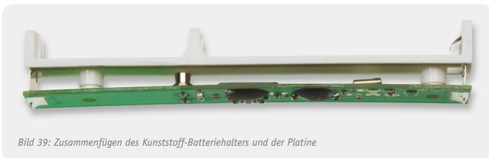
Bild 39: Zusammenfügen des Kunststoff-Batteriehalters und der Platine
