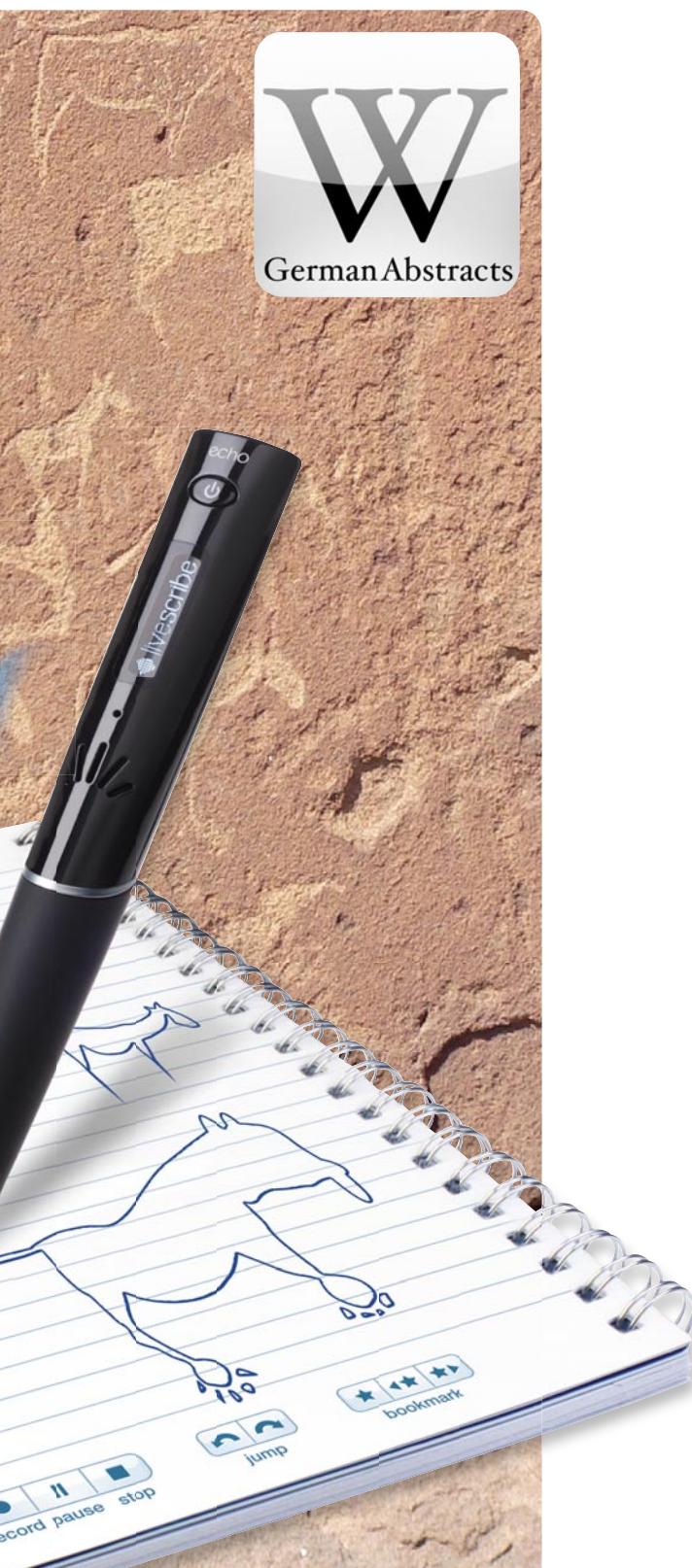
Bild 1: Notiz und das gesprochene Wort finden im Livescribe Echo Smartpen in synchronisierter Form zueinander (rote Pfeile). Über eine USB-Verbindung findet der Inhalt seinen Weg auf die Festplatte eines PCs oder Laptops, zum Pencast ins Internet oder zur Nachbearbeitung (grüner Pfeil). Quelle: teilweise Livescribe
