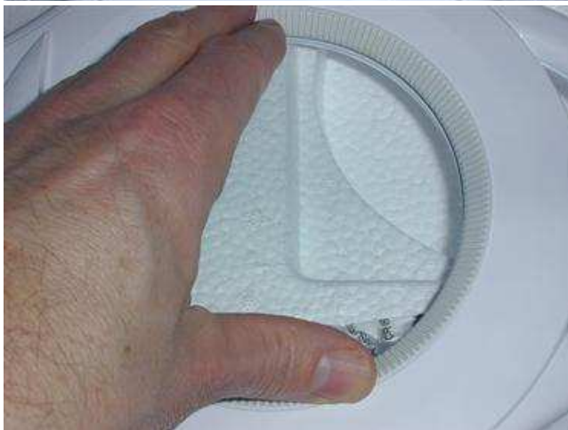
Zum Lösen des Linsen-Befestigungsringes ist dieser, wie im Bild gezeigt, nach links bis zum Anschlag zu drehen.
