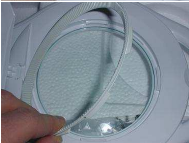
Jetzt kann der Ring entnommen und die Linse ausgetauscht werden. Nach dem Einlegen der neuen Linse ist der Befestigungsring wieder einzusetzen und bis zum Anschlag nach rechts zu drehen.
