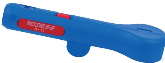
Der Rundkabel-Stripper No. 13 sorgt für ein sicheres und komfortables Entmanteln aller gängigen Rund- und Feuchtraumkabel mit einem Durchmesser von 6,0 - 13,0 mm. (z.B. NYM-Kabel 3 x 1,5 mm<sup>2</sup> bis 5 x 2,5 mm<sup>2</sup>) Die Schnitttiefe muss nicht extra manuell reguliert werden. Der neue Arbeitsbereich eignet sich somit auch für kleinere Leitungsdurchmesser ab 6 mm, wie z.B. 3 x 0,75 mm<sup>2</sup>. Durch die ergonomische Griffform ist das Werkzeug besonders gut in der Handhabung.
