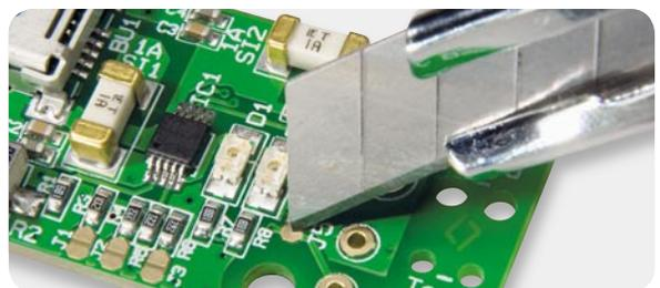
Bild 6: J 5 ist bei angeschlossenem Temperatursensor aufzutrennen.
