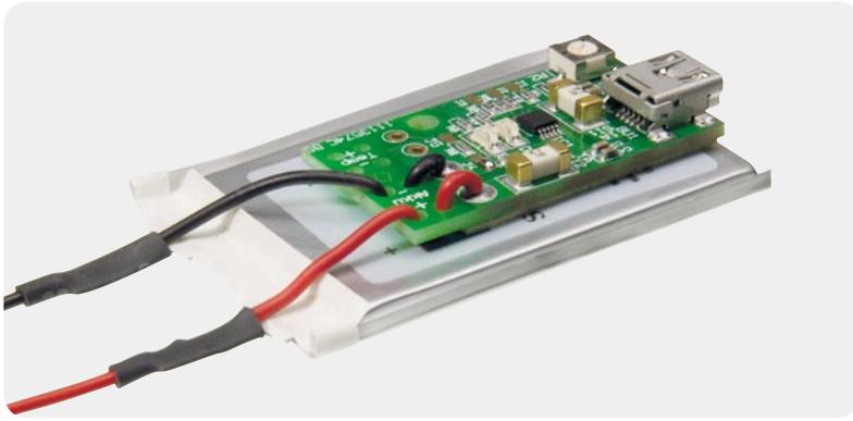
Bild 1: Lithium-Akku mit kompletter Lade-Elektronik
