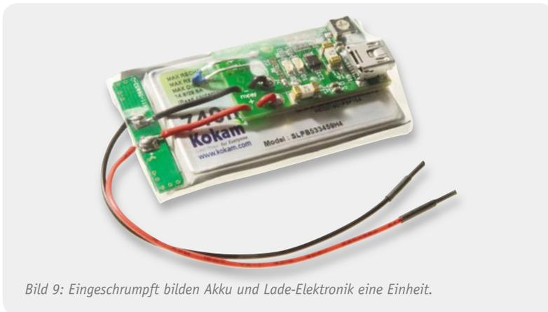
Bild 9: Eingeschrumpft bilden Akku und Lade-Elektronik eine Einheit.
