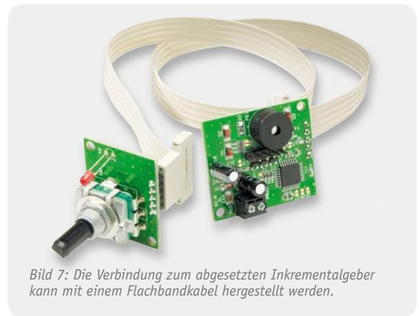
Bild 7: Die Verbindung zum abgesetzten Inkrementalgeber kann mit einem Flachbandkabel hergestellt werden.
