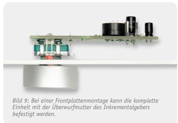
Bild 9: Bei einer Frontplattenmontage kann die komplette Einheit mit der Überwurfmutter des Inkrementalgebers befestigt werden.
