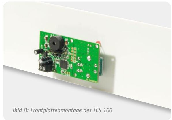
Bild 8: Frontplattenmontage des ICS 100
