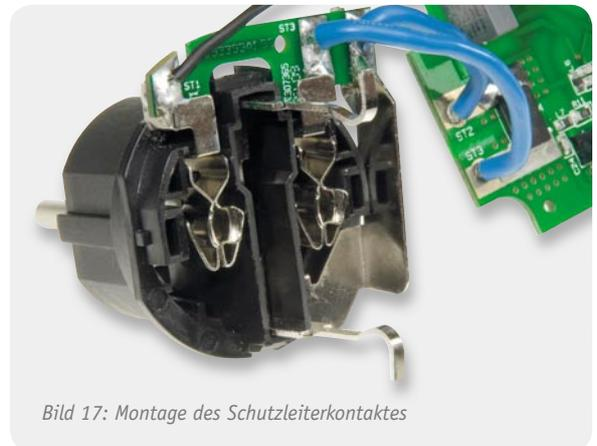
Bild 17: Montage des Schutzleiterkontaktes
