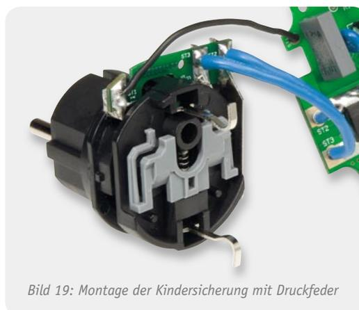
Bild 19: Montage der Kindersicherung mit Druckfeder
