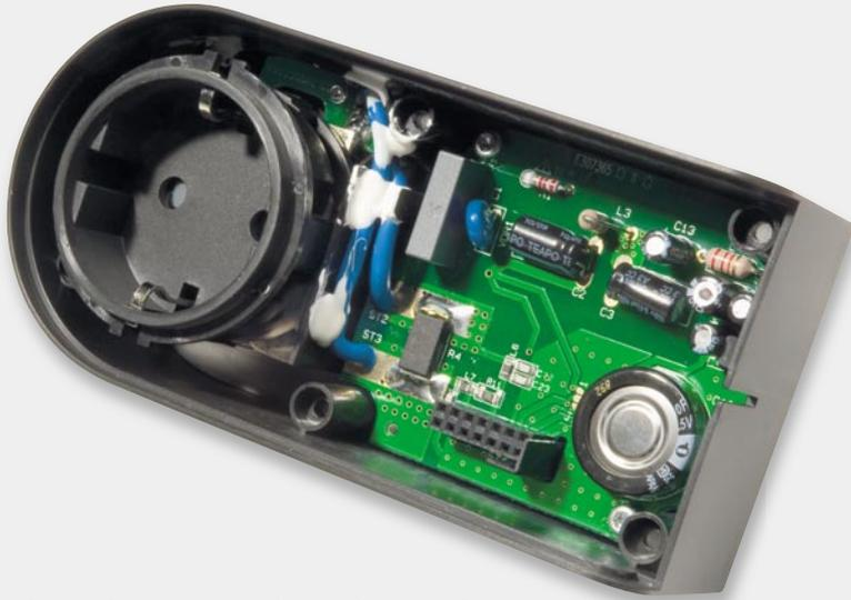
Bild 21: Innenansicht des fertig aufgebauten Gehäuseunterteils
