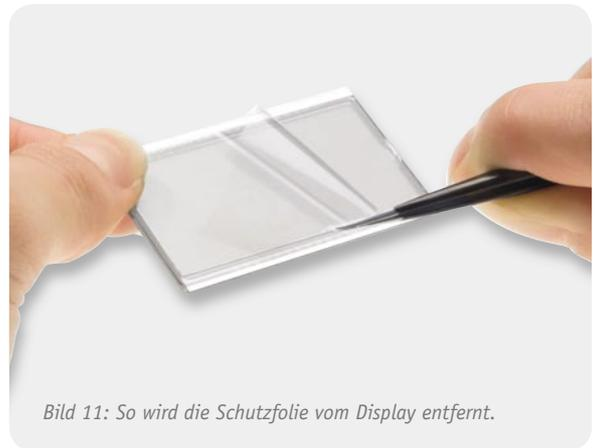
Bild 11: So wird die Schutzfolie vom Display entfernt.
