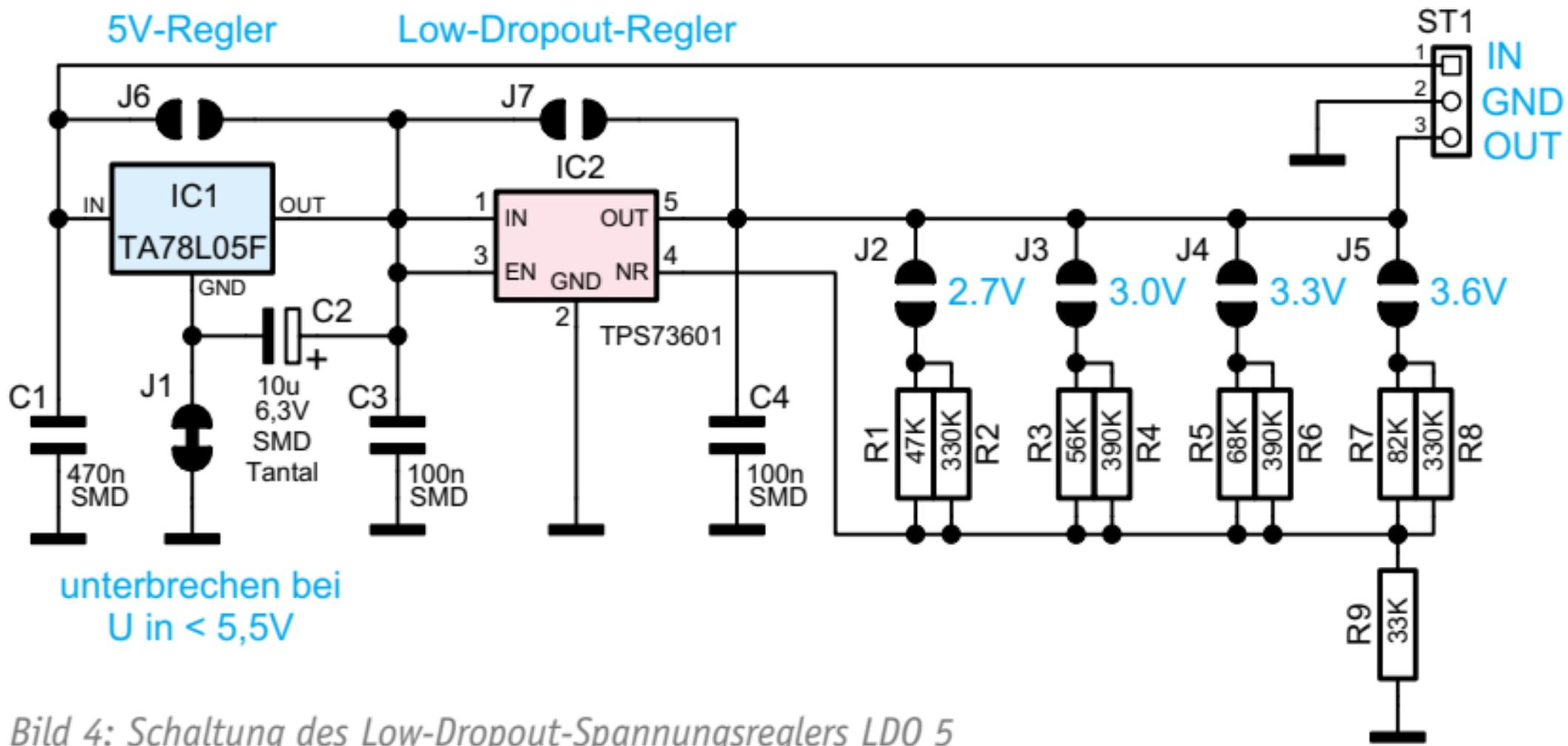
Bild 4: Schaltung des Low-Dropout-Spannungsreglers LDO 5
