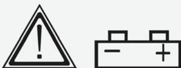
Bei unsachgemäßem Einsetzen bzw. Austausch der Batterie besteht Explosionsgefahr! Ein Einsetzen der Batterie mit einem metallischen Gegenstand, wie z. B. einer Zange oder einer Pinzette, ist nicht erlaubt, da die Batterie hierdurch kurzgeschlossen wird.
