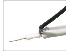
Bild 5: An die Abschirmung des Koax-Kabels ist eine einadrige Leitung anzulöten.
