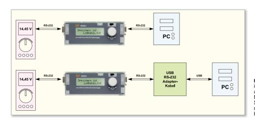
Bild 13: Einfügen des SDSD1 in eine RS232-Verbindung auf Geräteebene – hier ein Multimeter mit serieller Schnittstelle an einen PC mit RS232 (oben) und mit USB-Port (unten). Im Gegensatz zu den Spannungspegeln der RS232-Schnittstelle (TTL: High-Bit = 3-15 V, Low-Bit = 0-1,3 V) werden die Spannungspegel an diesen Eingängen nicht invertiert (TTL: High-Bit = 0-1,35 V, Low-Bit = 3,15-5 V), bevor sie zum aufzeichnenden Mikrocontroller des SDSD1 gelangen.
