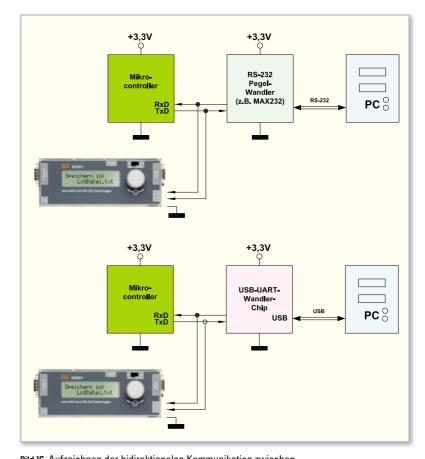
Bild 16: Aufzeichnen der bidirektionalen Kommunikation zwischen einem Mikrocontrollersystem und einem PC über die TTL-Schnittstelle des SDSD1. Oben bei einer RS232-PC-Verbindung und unten bei einer USB-PC-Verbindung mit Hilfe eines USB-Treiber-Chips.
