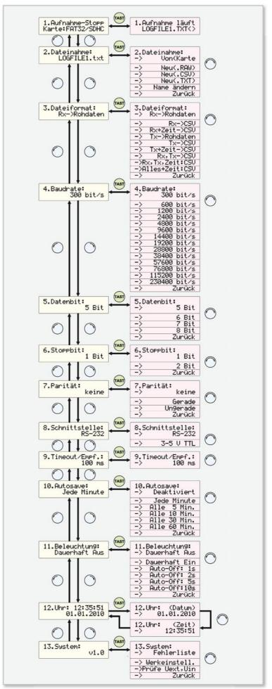
Bild 18: Menü und Konfigurationsparameter des SDSD1
