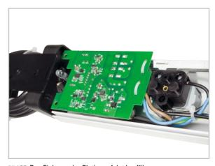
Bild 28: Das Einlegen der Platine erfolgt kopfüber.
