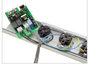
Bild 25: Das Verkabeln der beiden schwarzen Adern des Schaltausgangs
