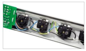
**Bild 29:** Vor dem Zusammenbau des Gehäuses werden die einzelnen Adern, wie hier gezeigt, mit Kabelbindern fixiert.
