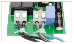
Bild 26: Die Kabel sind auf der Platine mit Kabelbindern zu fixieren.
