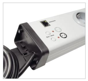
Bild 32: Nach abschließender Sichtkontrolle zum richtigen Sitz von Netzwerkbuchse, Tastern und LEDs können die Endkappen aufgeschraubt werden.
