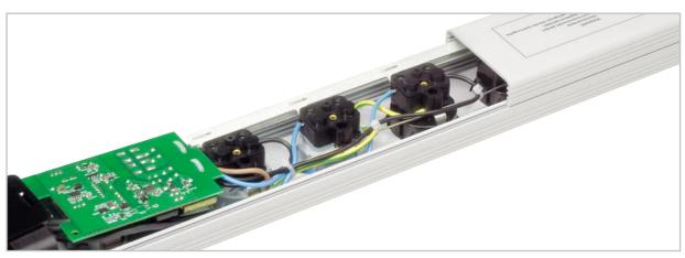
Bild 30: Das Gehäuseunterteil wird vorsichtig bis heran an die Elektronikplatine aufgeschoben.
