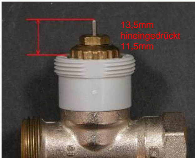
richtig montierter Adapter
