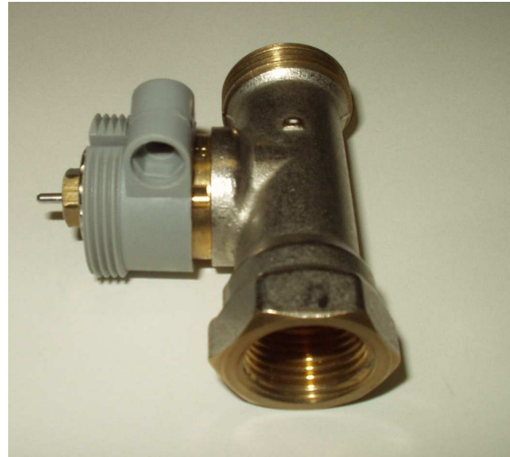
falsch montierter Adapter
