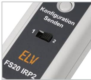
**Bild 15:** Auswahlschalter für die zwei Konfigurations-Speicherplätze
