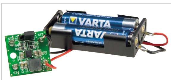
Bild 3: Zur Speisung des Spannungswandlers können optimal ein oder zwei Alkaline-Zellen genutzt werden.
