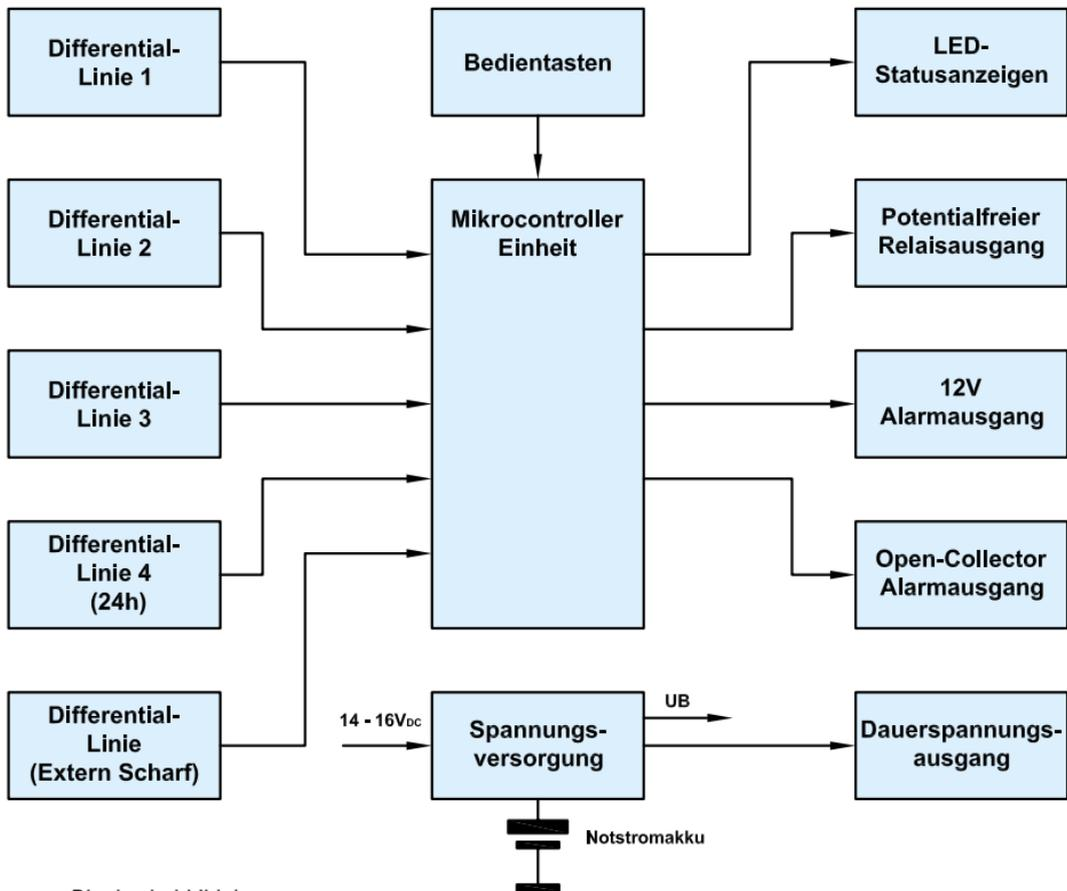
Bild 5: Blockschaltbild der Alarmzentrale AZ4-2
