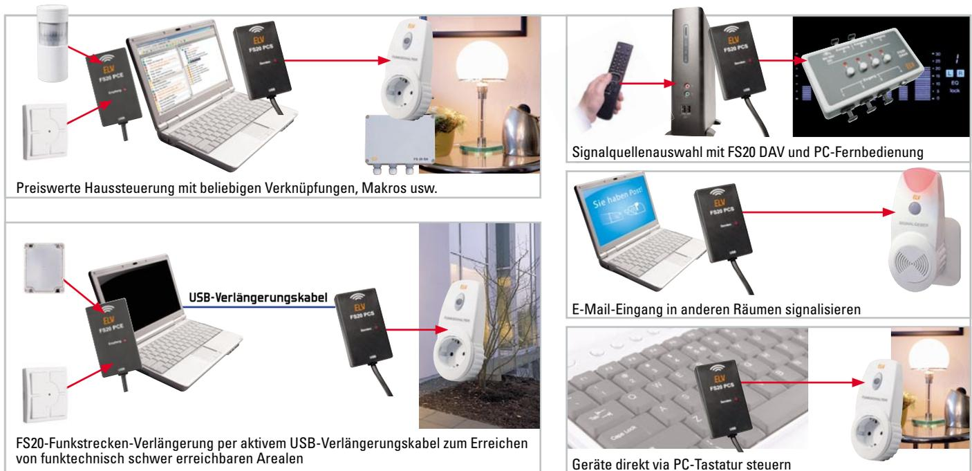
Bild 1: Einige denkbare Anwendungen des FS20 PCS. Auch eine Kombination mit dem FS20 PCE (siehe Vorschlag links oben und unten) ist möglich.
