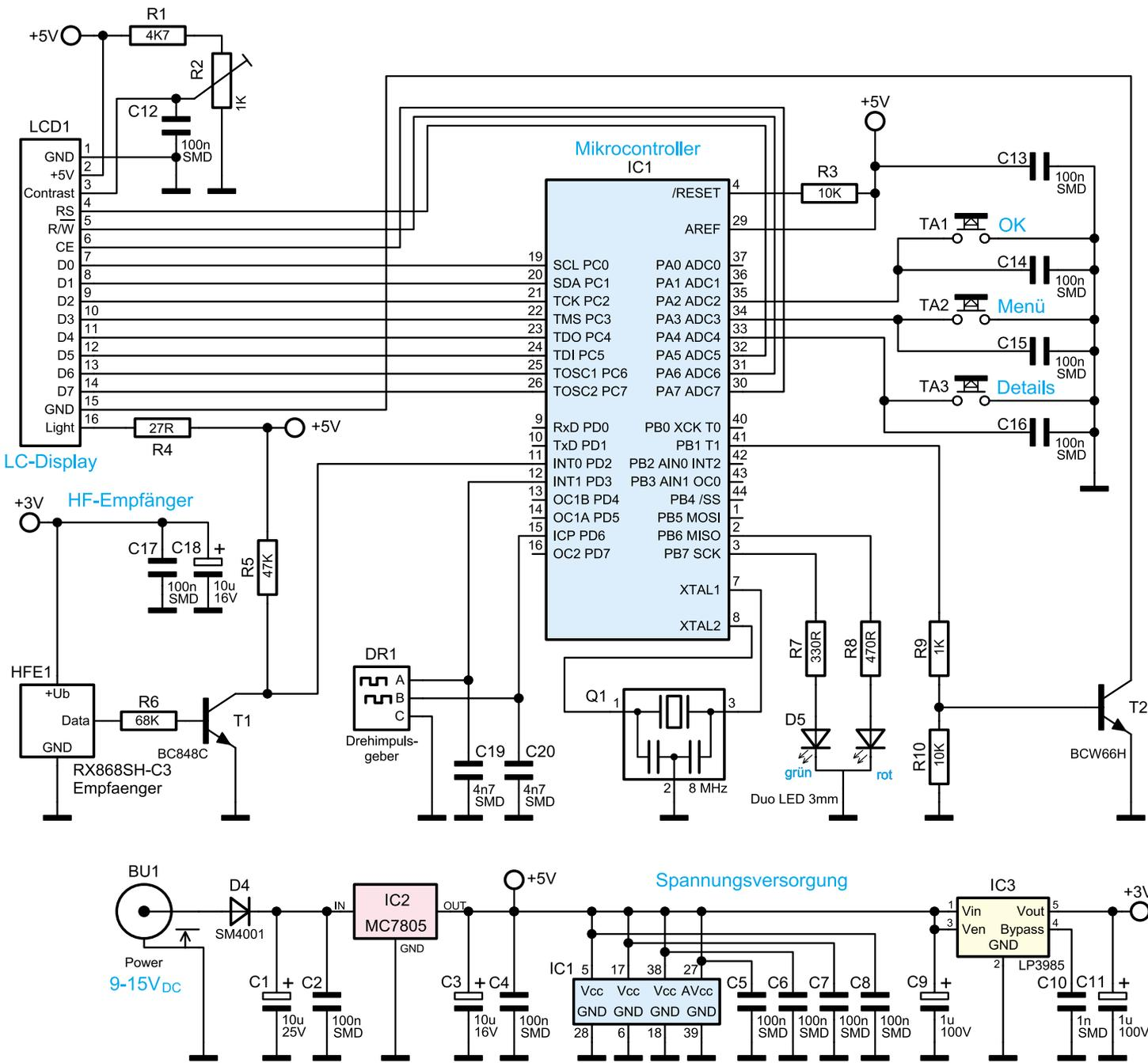
Bild 4: Die Spannungsversorgung und Schaltung der FHT8-SA
