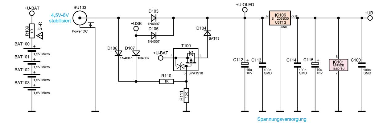
Bild 4: Oben das Schaltbild des UTK 100, unten die Stromversorgung
