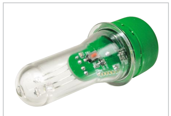
Bild 7: Das fertig montierte aktive Katzenauge
