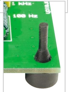
**Bild 6:** So erfolgt das Einsetzen der GummifüÙe in die Platine.
