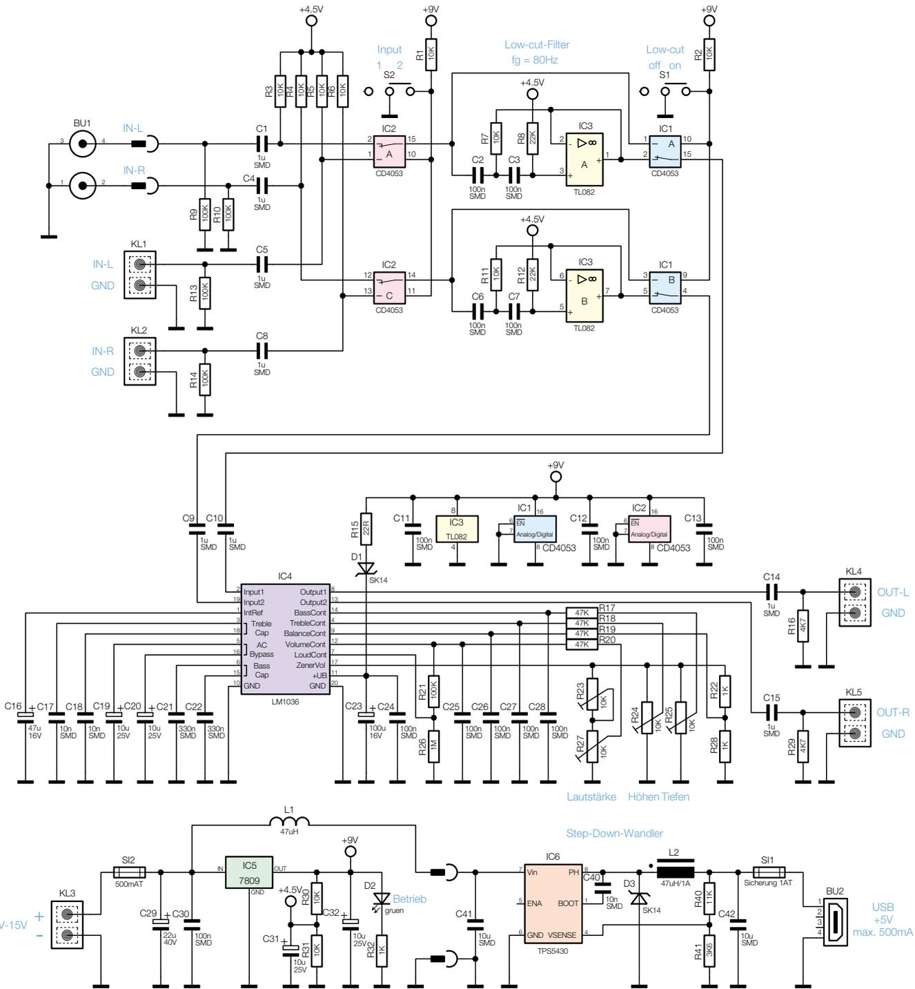
Bild 3: Das Schaltbild der Klangregelstufe, unten die Spannungsaufbereitung
