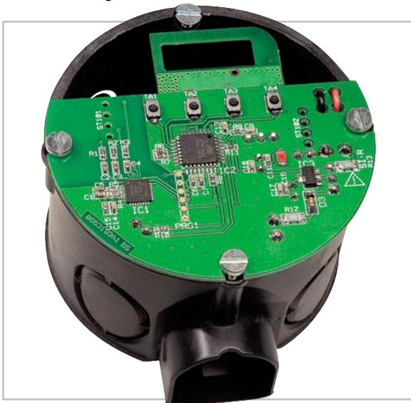
**Bild 2:** Montage der Basiseinheit auf eine Unterputzdose
