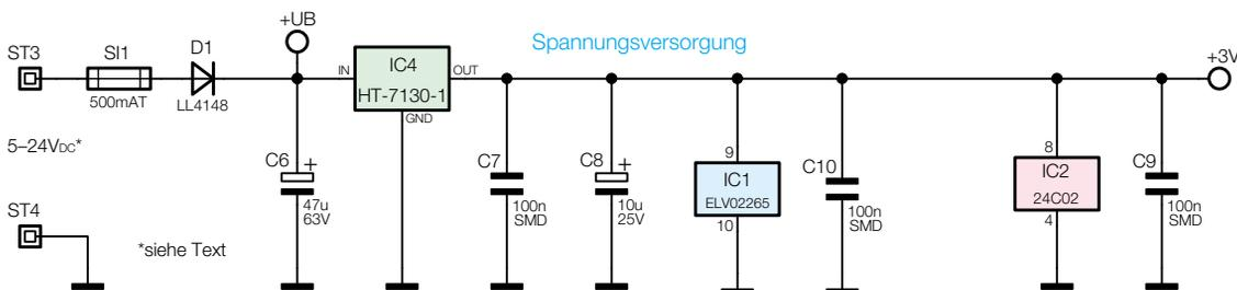
**Bild 6:** Spannungsversorgung des FS20-Universal-Empfängers
