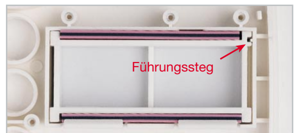
Bild 8: Montage des Halterrahmens und der Leitgummistreifen
