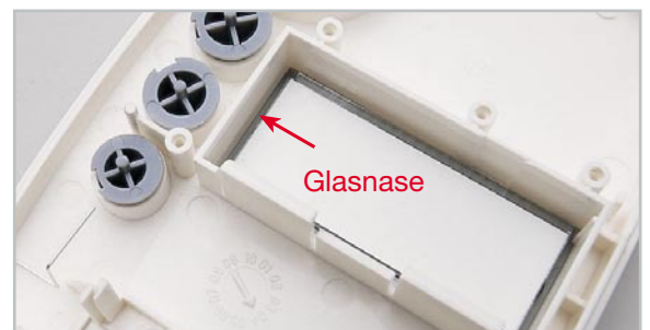
Bild 7: Polarisrichtiges Einsetzen des Displays
