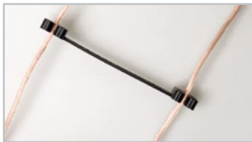
Bild 6: So werden die Abstandshalter an der Messleitung angebracht
