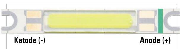
Bild 1: Die 3-W-Flächen-LED. Man erkennt die Polarität an der Strichmarkierung (Anode).
