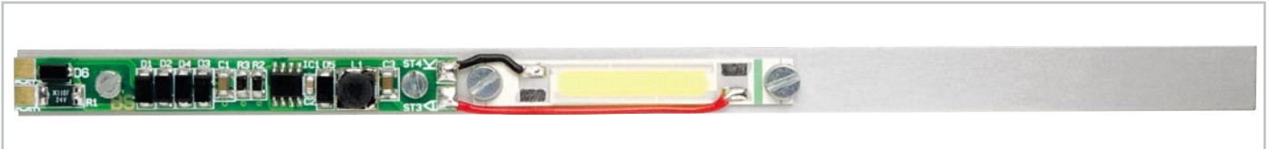
Bild 4: Die auf das Aluminiumprofil montierte Steuerschaltung und die LED mit der Verdrahtung zwischen LED und Steuerschaltung
