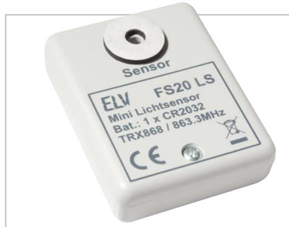
**Bild 7:** Die Rückseite des FS20 LS mit Sensoröffnung und aufgeklebtem Schaumstoffring gegen seitliches Streulicht
