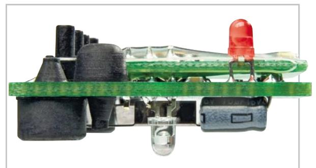
**Bild 4:** Seitliche Ansicht der Platine mit Anordnung von Leuchtdiode, Fototransistor und Funkmodul. Hier sind gut die Abstände von LED und Fototransistor zur Platine sowie das direkt aufliegende Funkmodul zu sehen.
