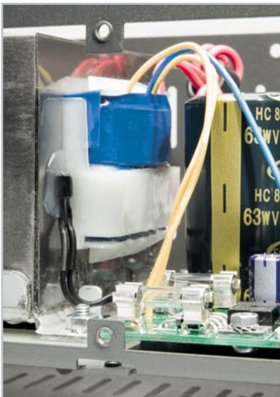
Bild 17: Befestigung des Temperatursensors am Trafo
