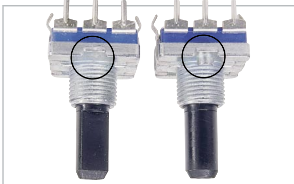
Bild 11: Die Führungsnase des Inkrementalgebers (rechts) wird abgeschnitten (links).
