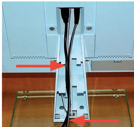
6. So werden die Kabel angeschlossen, in die Fußstütze eingelegt und geführt. Darauf achten, dass die Kabel wie gezeigt tatsächlich in der Mitte liegen, um das spätere Einrasten des Deckels nicht zu behindern.
