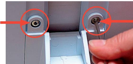
5. Fußstütze mit dem beiliegendem Inbusschlüssel und 2 Inbusschrauben an der Wetterstation verschrauben
