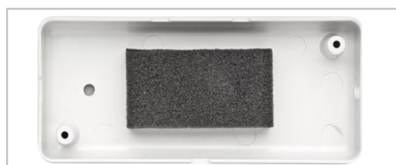
Bild 17: Die richtige Position des Schaumstoffstücks im Gehäusedeckel
