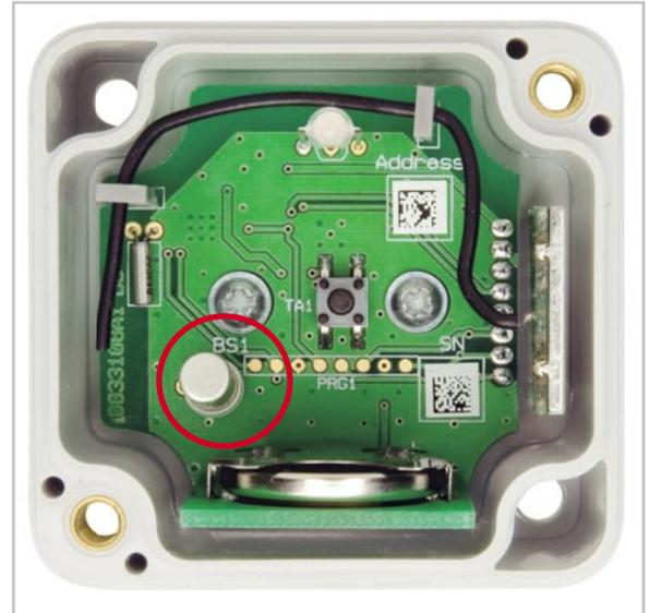
**Bild 6:** Komplett bestückter und montierter Aufbau des Funk-Neigungssensors HM-Sec-TiS. Genau in dieser Lage (LED oben, Sensor links unten [roter Kreis]) ist das Gerät später an den zu überwachenden Gegenstand zu montieren.
